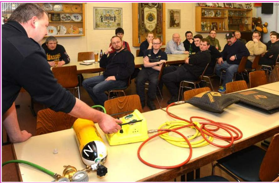
zum Platzen bringen. Daher müsse man nicht ständig auf die Druckanzeige schießen, sondern könne sich auf das sichere Anheben der Last konzentrieren. Mit bis zu acht bar werden die Kissen verschiedener Größen aufgeblasen. Die Reichenbacher Wehr verfügt jetzt über drei Versionen, mit denen man zehn, zwölf oder 18 Tonnen anheben kann. Aufgebaut sind die Werkzeuge ähnlich wie Autoreifen. Ein Stahl-Cord (oder Gewebe-Cord) ist mit Gummi ummantelt. Ähnlich empfindlich wie Auto-
