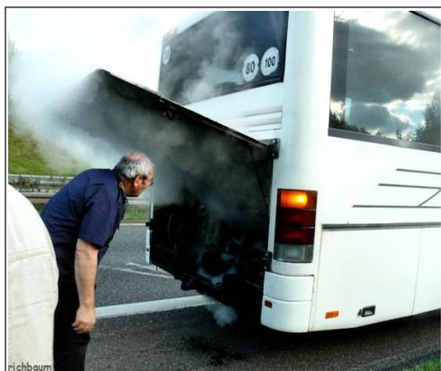
Der Fahrer öffnete die Motorhaube und stellte fest, dass eine Gummimanschette defekt war, wo dann die Kühlflüssigkeit austrat. Er konnte den Fehler reparieren, Wasser zum Auffüllen wurde dem Toilettentank entnommen, allerdings war nicht genug vorhanden, so dass der mittlerweile angekommene Autobahnpolizist dem Fahrer zu Auflage machte, die nächste Abfahrt zu benutzen, um genügend Kühlwasser aufzunehmen.
